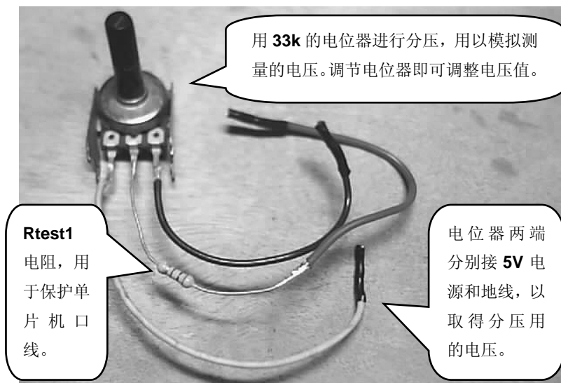
例图 12.2 准备分压电位器
